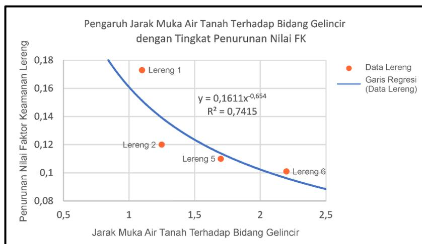
**Gambar 9.** Korelasi antara jarak muka airtanah terhadap bidang gelincir dan penurunan nilai FK lereng. semakin besar jarak airtanah terhadap bidang gelincir semakin rendah tingkat penurunan nilai FK.
