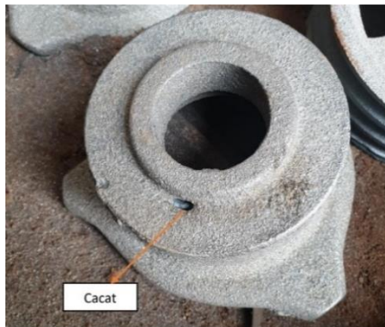
Gambar 2. Cacat yang terjadi pada pengecoran engine pulley
