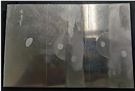
**Gambar 1** Proses *blend out* spesimen
