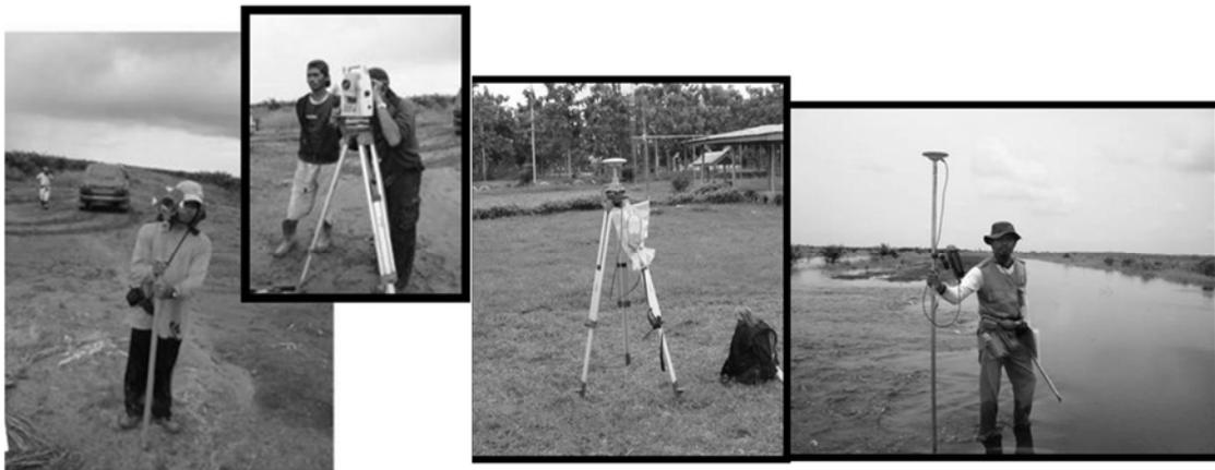
Gambar 1. Pemetaan kontur lahan menggunakan Total Station dan GPS Geodetik
