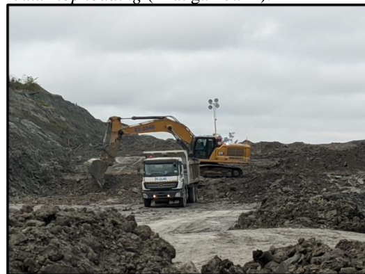
Gambar 1 Pola Pemuatan Single Back Up dan Top Loading
