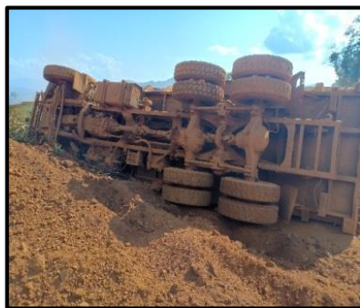
Gambar 4.4 Dumphtruck yang terperosok akibat jalan yang bergelombang dan berlubang ketika diguyur hujan.
