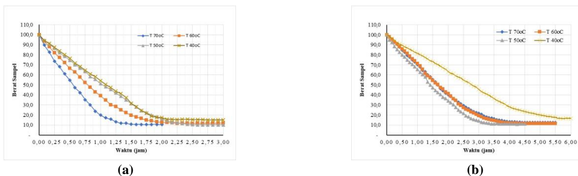
Gambar 2. Berat Sampel Tomat, (a) tebal padatan 2 mm, (b) tebal padatan 4 mm
