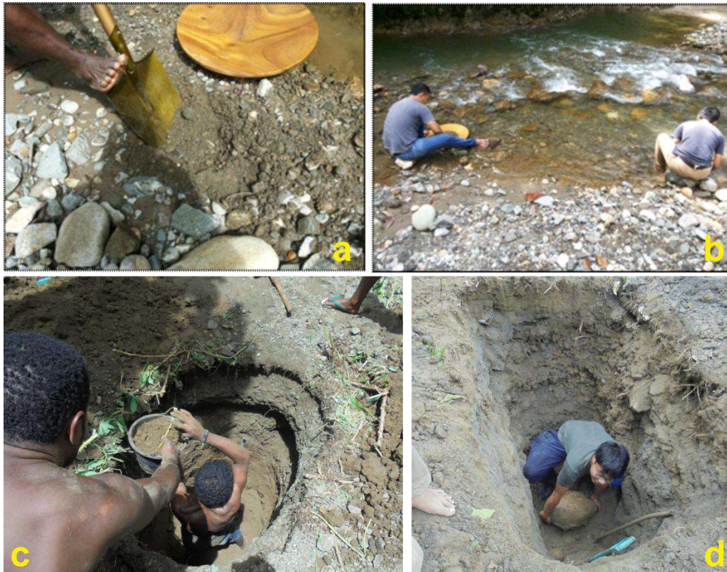
Gambar 10a-b. Kegiatan Panning (Pendulangan) Point Bar di Daerah penelitian. c-d. Kegiatan Penggalian Test Pit (Sumur Uji) di Daerah Penelitian
