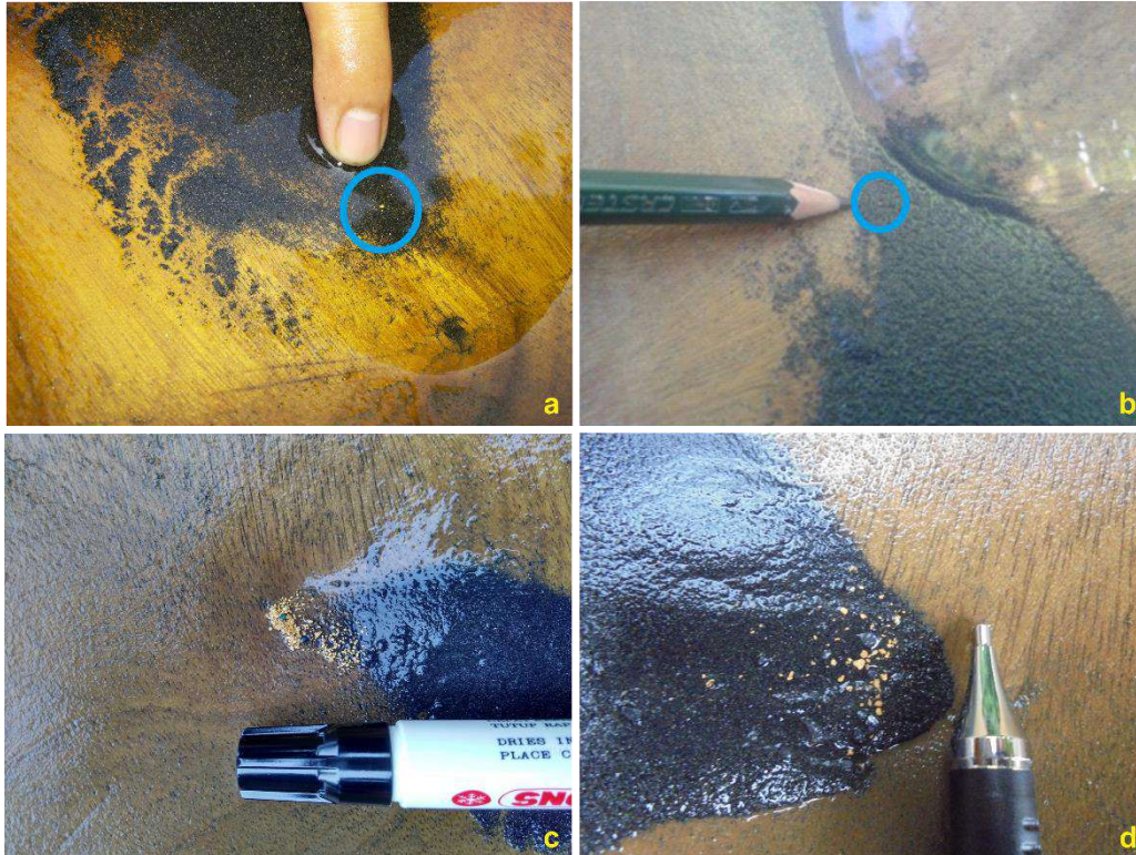
Gambar 11a-b. Hasil pendulangan pada material hasil pembuatan sumur uji pada titik TP-02 dan TP-03. c-d. Hasil pendulangan dari material pada point bar sungai di titik PS-05 dan PS-02.
