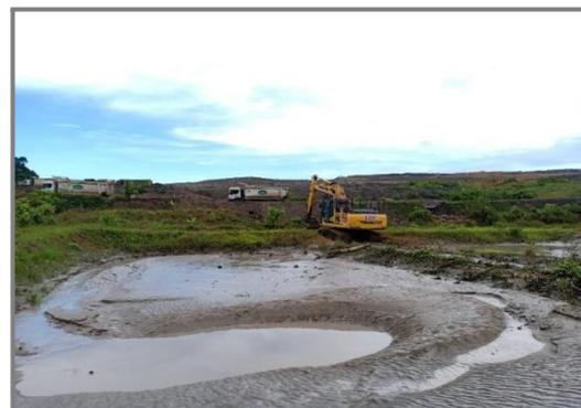
**Gambar 6.** Pendangkalan pada *Settling Pond*
