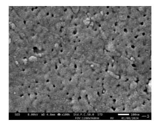
**Gambar 2**. Morfologi Permukaan Membran PSF dengan Zeolit 200 ppm
