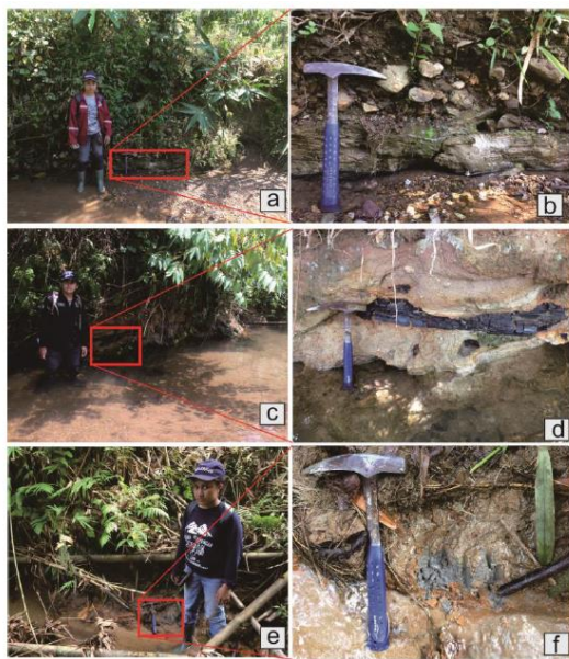
Gambar 3. Ciri litologi pada Satuan Batupasir Talangakar : (a) singkapan batupasir halus; (b) litologi batupasir halus (c) singkapan batupasir kasar masif dengan cerat batubara batubara; (d) litologi batupasir kasar masif dengan cerat; (e) singkapan batulempung masif; (f) litologi batulempung masif
