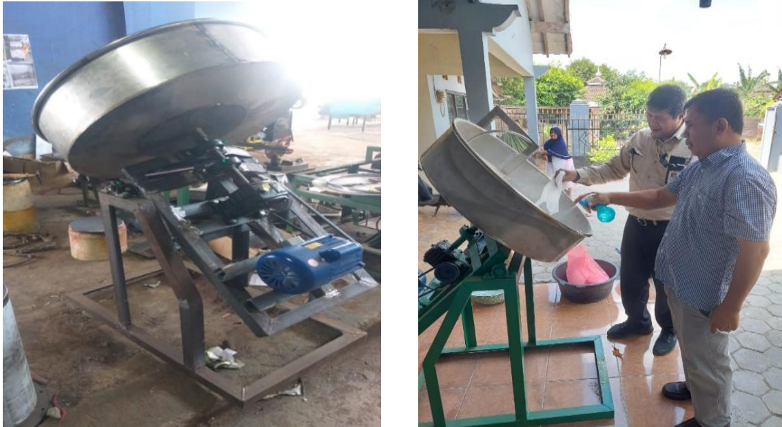
Gambar 4. Mesin penginter tepung gaplek selesai dibuat
