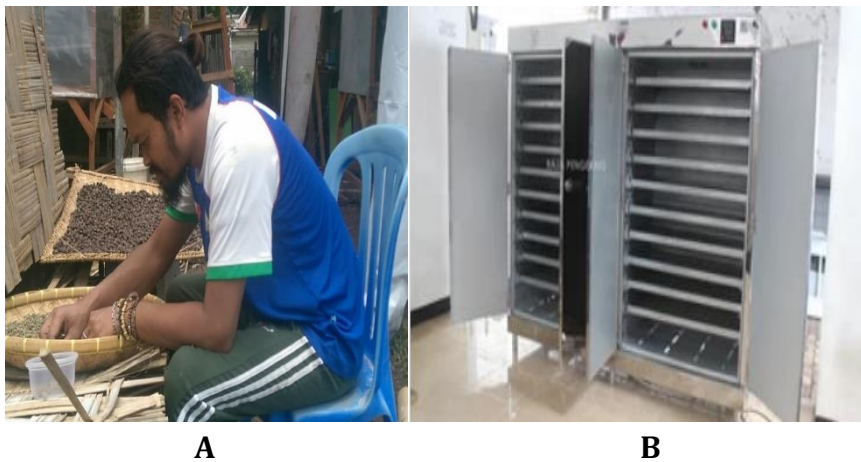
Gambar 2. A. pengeringan tradisional yang saat ini dilakukan oleh mitra B. lemari pengering biji dan kulit kopi dilakukan secara moderen
